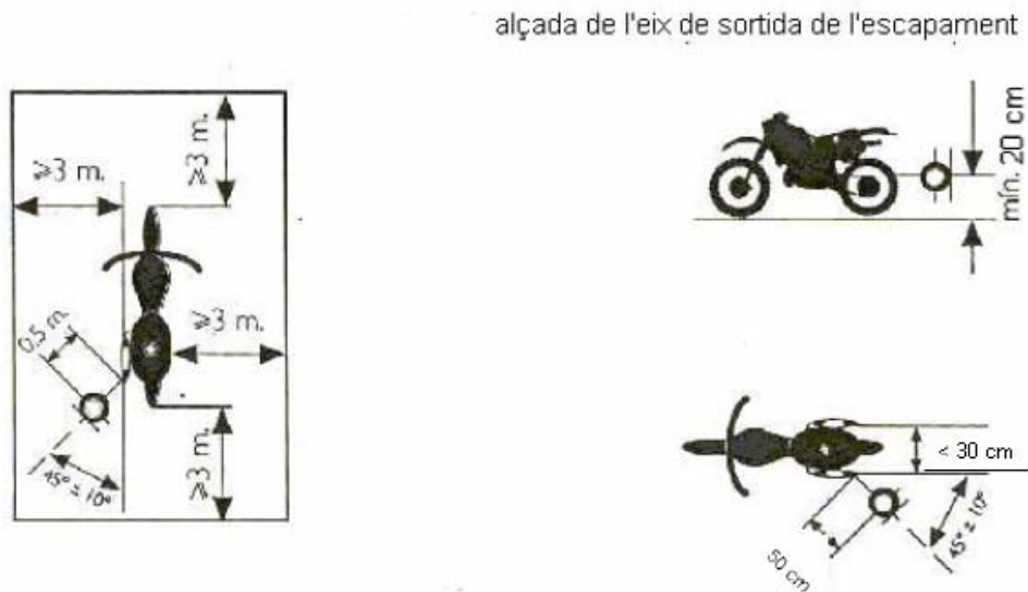
Figura 2. Posició de l'instrument de mesura en vehicles amb tub d'escapament vertical
